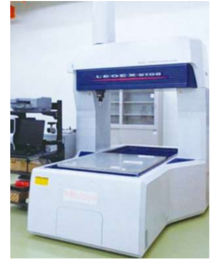
三次元座標測定機 この装置によるJCSS校正は日本では都産技研のみで実施している。
