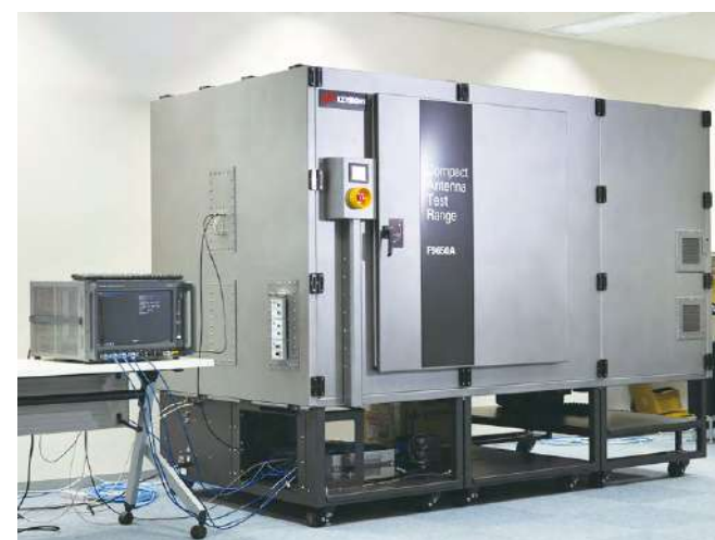
図2 5G 端末測定用設備 (基地局エミュレータおよびコンパクトアンテナテストレンジ)
