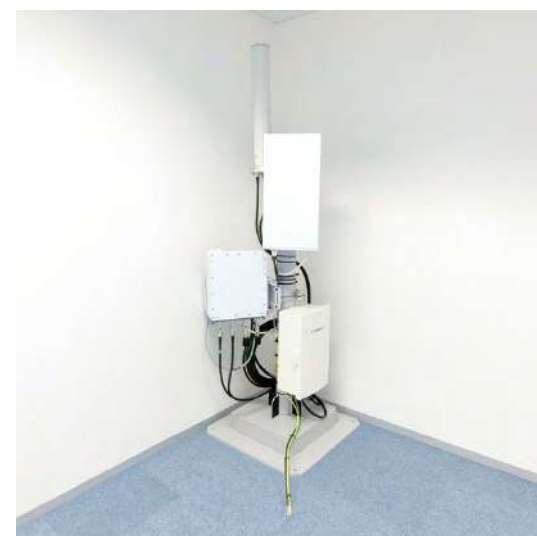
図1 ローカル5G基地局（ミリ波帯：28 GHz）
