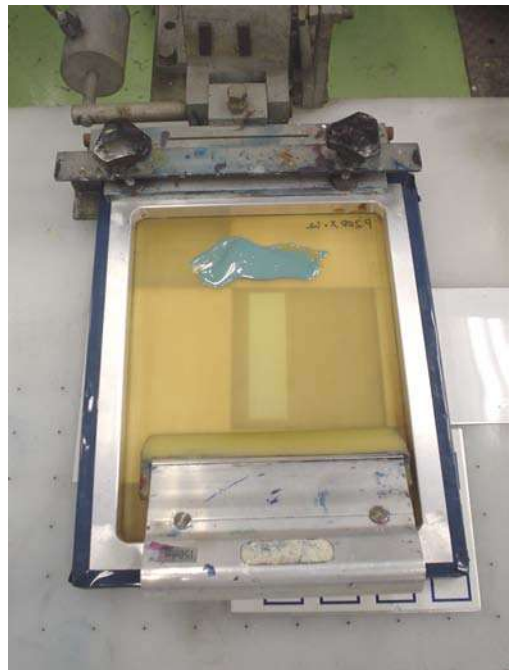
図3 ガラス基板上へのオーバーコート膜形成印刷例 (図のペーストには無機顔料は混合してない)
