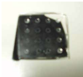
図10 熱融着条件が不良で溝が消失したチップ
