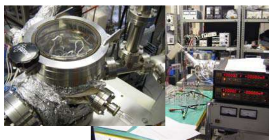
図1 CNT膜の電子放出特性の分析評価装置 左：真空チャンバー，右：制御及び計測器
