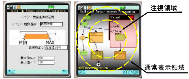
図3. 状態個別動作編集画面(左)と視覚化による表示効果(右)
