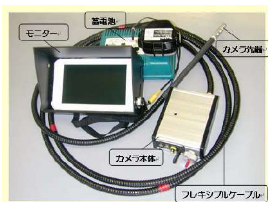
図 3. 開発したマンホールカメラシステム全体
