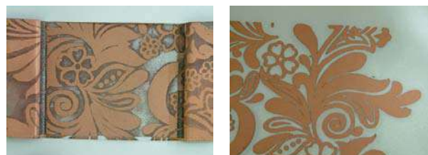
図2. パラジウム付与布への無電解めっき
