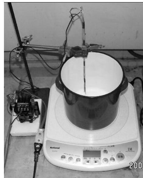
図 5. バッチ式蒸発器の自動切断システム
