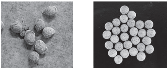
図1. リン吸着用ブラウン管パネルガラス焼結体の概観 (左) 押出成型方式で造粒した焼結体 (右) ロール方式で造粒した焼結体
