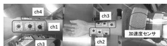
図 3. センサ装着位置 (左), (中央) 筋電センサ (右) 加速度センサ
