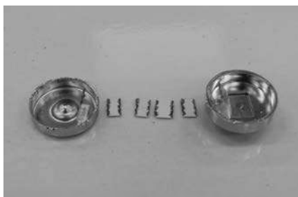
図 12. 溶断したヒューズエレメント
