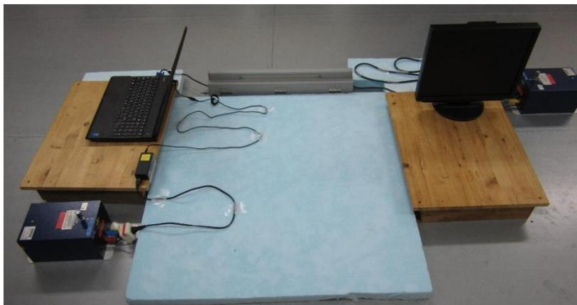
配置の例（EUT：ノート PC AE：ディスプレイ 注入法：クランプ注入）
