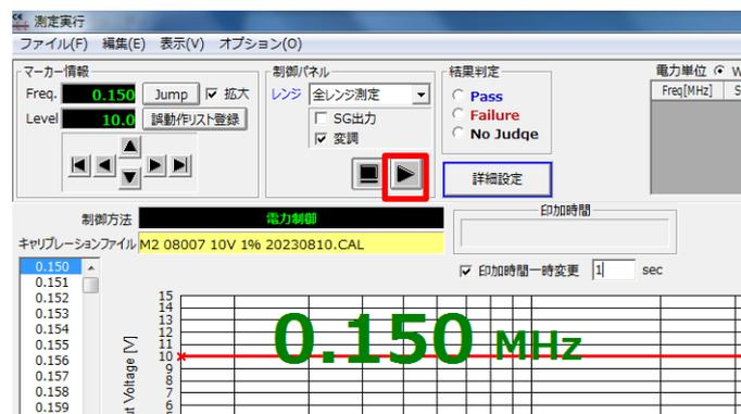
試験中に停止する場合は制御パネルのストップボタンを押してください。
