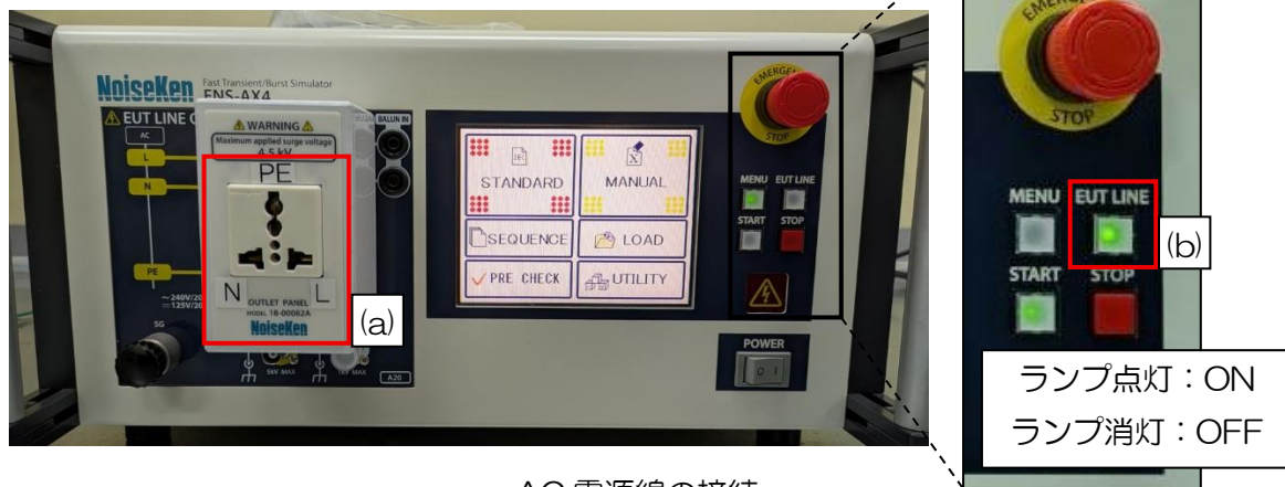
AC 電源線の接続
