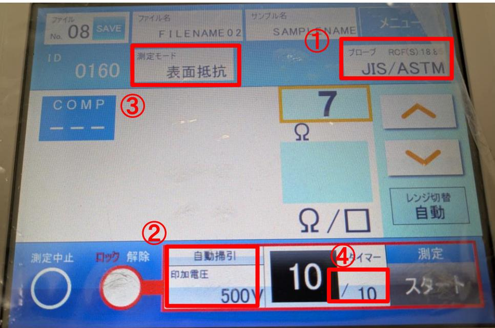
① 【プローブ】が【JIS/ASTM】選択されているか確認する(J-BOXが接続されていれば自動で【JIS/ASTM】が選択される)
