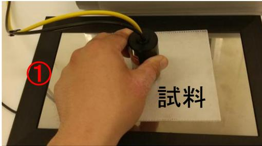
① プローブの電極部を試料に押し当てる
