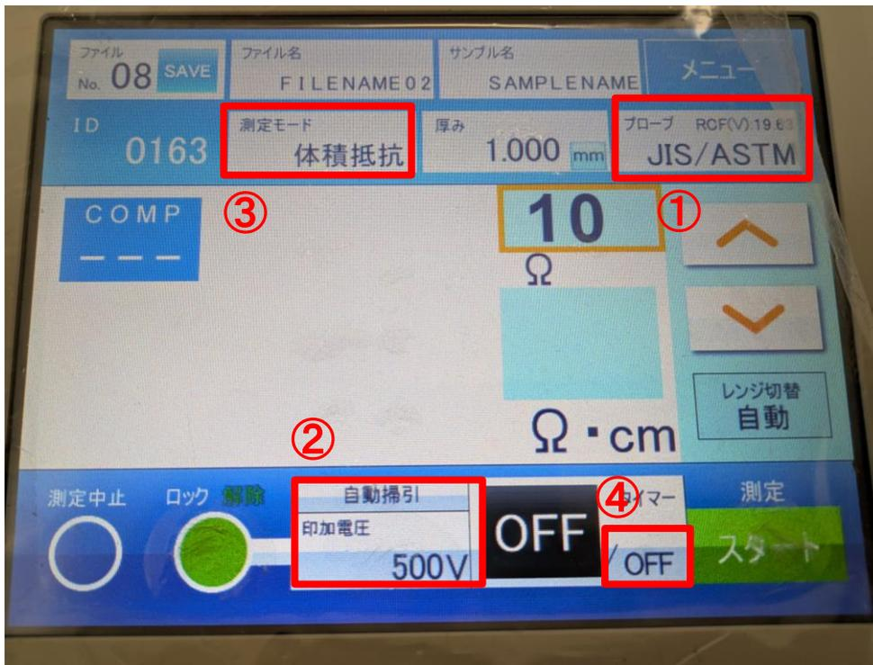
① 【プローブ】が【JIS/ASTM】選択されているか確認する(J-BOXが接続されていれば自動で【JIS/ASTM】が選択される)
