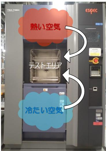
上部・下部の槽で、温度を調整した空気をあらかじめ作製し、すばやくテストエリアに送り込むことができます。そのため、通常の恒温槽よりも急激な温度変化を与えることができます。
