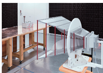
▶テストベンチ：W 3.0 m x D 1.0 m x H 0.9 m
