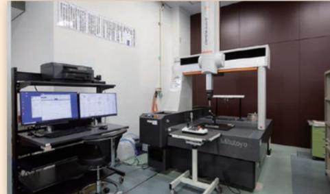
三次元測定機は、測定対象物に測定子を直に接触させて、縦、横、高さ(XYZ)の三方向からの座標情報を得ることで、寸法、角度、輪郭形状、幾何偏差を測定する装置です。従来はマイクロメータやノギスなどで測定していた複雑なワークの各種寸法を、まとめて効率的に測定することができます。
