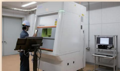
レーザによって金属やセラミックス、ダイヤモンドなどを除去し、三次元の立体形状をつくる加工機です。
