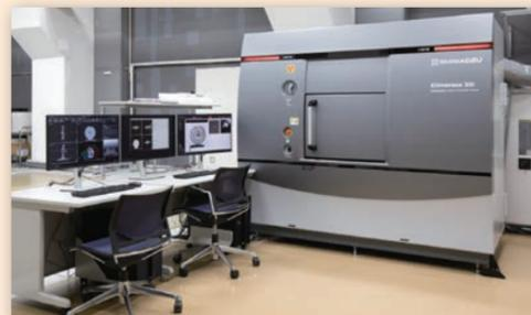
試料を壊さずに内部構造を三次元的に把握することができます。
