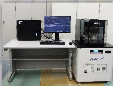
超微小押し込み硬さ測定機
