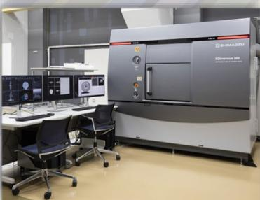
計測用X線CT装置
