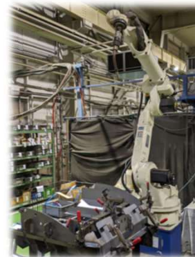
溶接ロボット
