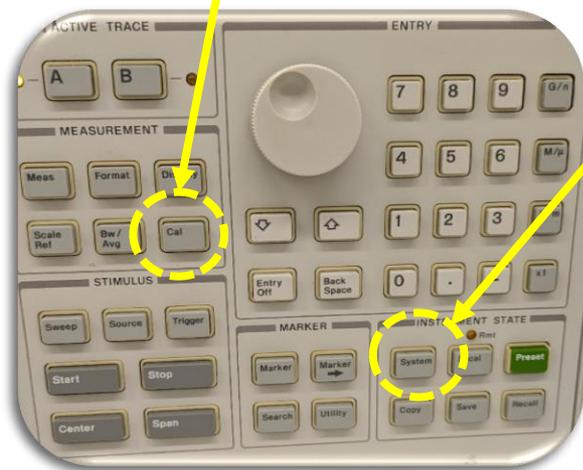
⑧ パネルのSystemキー選択して‘Store Device’を「Floppy」モード選択後「PERM1\_C.BAS」選択
