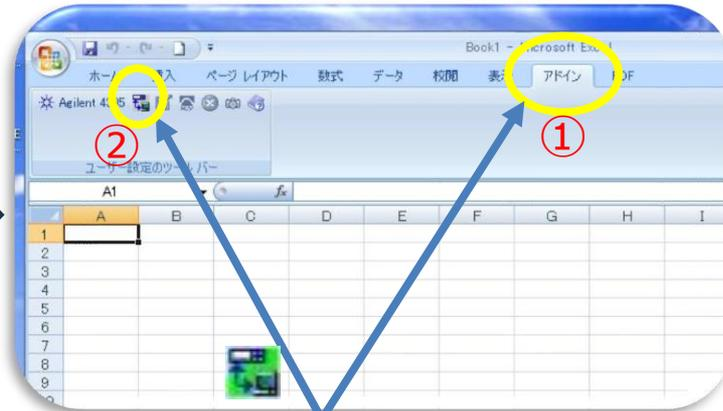
新規ファイルで上部ツールバーの「アドイン」タブを選択しAgilentのアイコン(Connect to Instrument)をクリック
