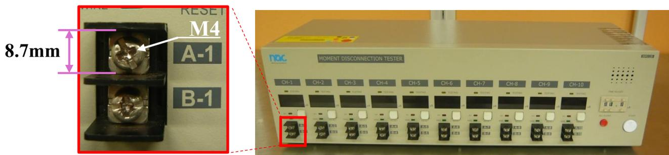
図1 検出器の外観と接続部の各種寸法
