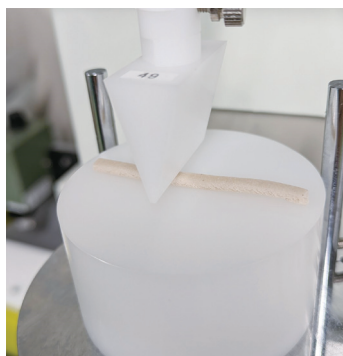
図1 一軸圧縮試験機による破断応力測定の様子
