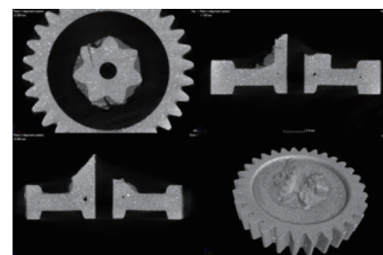
【ギアの亀裂確認】
