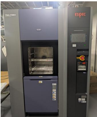
図1 熱衝撃試験機 中型
