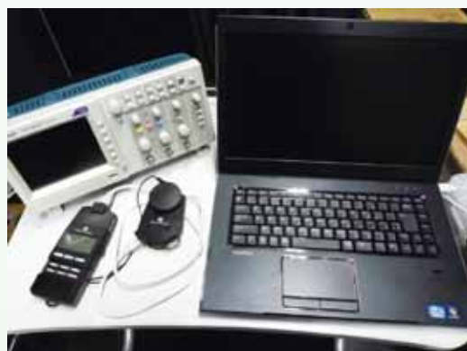
図2 光フリッカ測定装置
