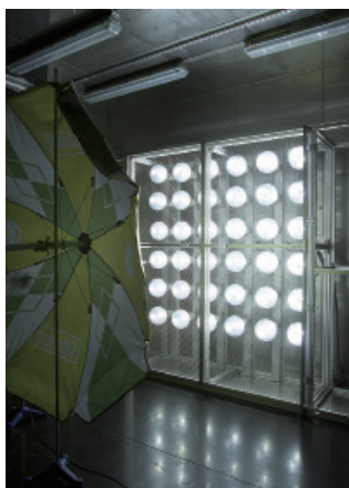
日射環境試験装置 (主室)
