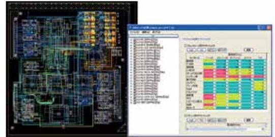
電子回路基板の不要な電磁波の発生場所と強度を、CAD上で確認できます。
