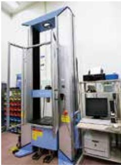
最大 100 kN (10 tonf) までの引張・圧縮・曲げの荷重を加えることができる試験機です。材料や製品の強度を評価できます。
