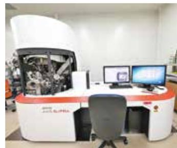
試料最表面 (数 nm) の元素分析やArイオンスパットによって深さ方向 (最大数百 nm程度) の元素分布を調べることができます。Arクラスターによるスパッタリングにも対応しているため、試料へのダメージを抑えた深さ方向分析も可能です。
