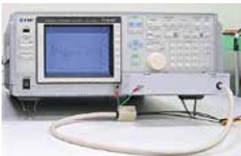
正弦波の信号を被測定物に与えて、その周波数応答を測定する機器です。100 Vを超えた高い電圧や0.1 mHzなどの超低周波数の測定が可能です。
