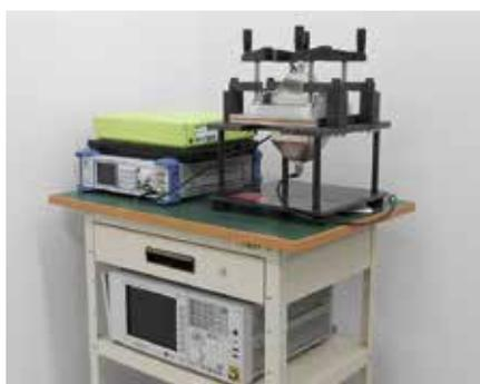
電気的特性を持つ導電性シートや磁性シートなどの電磁波遮蔽効果を評価します。電磁波の発生近傍 (近傍界) の遮蔽効果を電界あるいは磁界に分けて測定できます。
