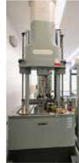
恒温槽により温度環境の変更(-40℃～+250℃)が可能な疲労試験機です。材料や製品に対して引張・圧縮・ねじりなどの動的荷重を作用させた際の疲労強度特性を評価します。
