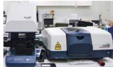
プラスチックなどの高分子材料や、有機系材料の分析に用います。
