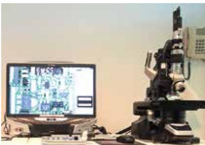
素材や製品の形状など表面状態の観察ができます。簡易計測や傾斜観察にも対応しています。
