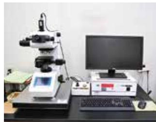
材料や製品のビッカース硬さを評価する試験機です。1 kgf以下の微小な荷重を用いて試験するため、薄物材料や微小部品の硬さ試験に適しています。
