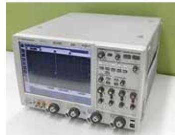
電子機器の通信電圧波形観測 (シリアル10 Gbpsまで) や各種電圧波形 (アイパターンやジッタ、FFTなど) を観測できる機器です。
