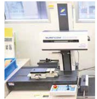
触針を変えることで、表面粗さと輪郭形状の測定に対応できます。
