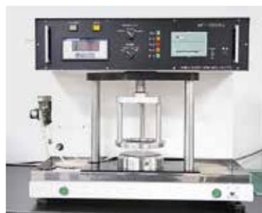
防水加工をした布などに水圧をかけて、どの程度の圧力で水が染み出すかを調べます。
