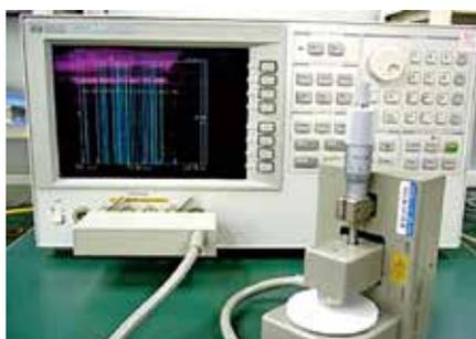
電子材料・非電気材料・電子部品の交流信号の流れやすさを示すインピーダンスを測定する機器です。測定周波数に対するインピーダンス特性を確認できます。治具を使用することで電気材料の誘電率や透磁率も測定できます。
