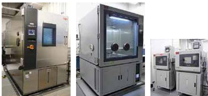
温度・湿度を制御して材料や製品を試験できます。急速温度変化タイプ（左）、前面ガラスタイプ（中央）や小型タイプ（右）があります。
