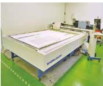
プリント型を用いず、繊維製品に直接色柄をプリントできます。
