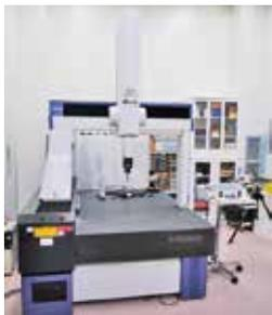
X、Y、Z軸方向にそれぞれ独立した測長スケールを持ち、機械部品や金型などの複雑な形状、穴位置、寸法などの幾何形状を自動的に測定できます。白色光源を用いた非接触式とプローブを用いた接触式があります。
