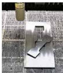
板材を任意の形状へ切断できる装置です。繊維強化プラスチック、金属、ガラスなどさまざまな材料が切断できます。
