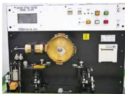
試料を摩擦した際に発生する帯電圧を測定し、帯電防止効果がどの程度あるかを評価します。
