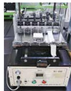
試料を往復摩擦し、色移りの度合いを調べます。平面型試料台を用いて塗装板などでの試験も可能です。
