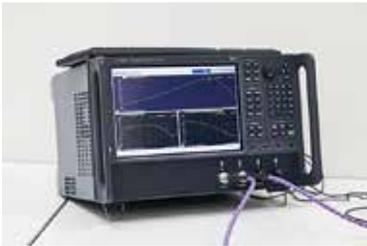
電子部品の電氣的な損失やインピーダンス、減衰特性の評価ができます。パワー半導体にバイアスを印加しながら、Sパラメーターが測定できます。
