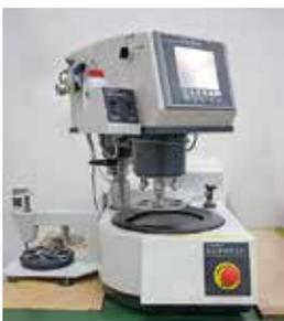
樹脂包埋された金属、セラミック、鉱物などの試料断面を研磨します。自動研磨ではφ30 mmまでの試料が利用できます。研磨盤サイズはφ200 mmで、研磨紙は#180～#2000までを準備しています。
