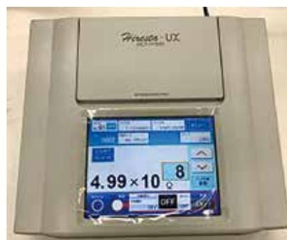
抵抗率が高い材料を測定する機器です。抵抗値が高い絶縁物にプローブを押し当てて、表面抵抗率および体積抵抗率を測定できます。
