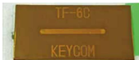
近傍の伝導ノイズを抑制するノイズ抑制シートの性能を評価します。伝送線路を伝わる伝導ノイズが、シートを装着した際の減衰状態を測定します。
