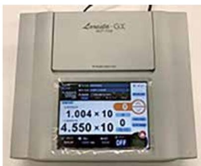
抵抗値の低い導電性材料や薄膜などを、プローブを押し当てる4探針法で測定する機器です。試料の厚みや形状から、表面抵抗率、体積抵抗率、導電率をリアルタイムに測定できます。
