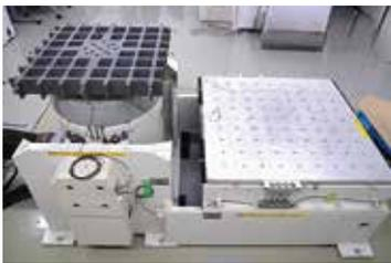
加振台に載せた製品に対して垂直・水平方向の機械振動を与え、さまざまな製品の振動耐久性を確認できます。
