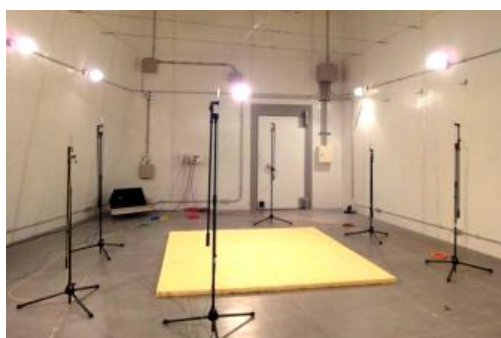
残響室法吸音率測定の様子
