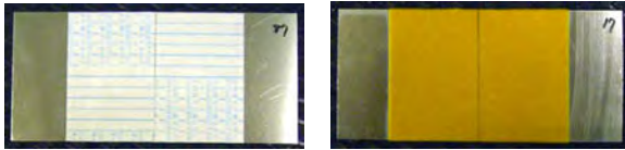
図3. 植毛用プレート (左:植毛前 右:植毛後)
