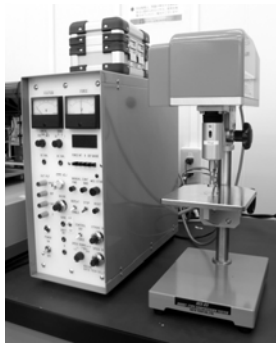
図5. 圧縮装置(KES-G5) 図6. 脚圧縮特性評価装置
