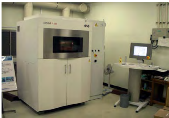
図 1. ナイロン粉末焼結型ラピッドプロトタイピングシステム
