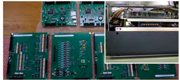
図 3. センシングモジュールの基板構成
