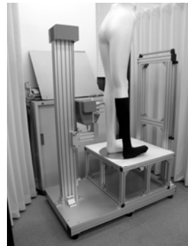
図5. 圧縮装置(KES-G5) 図6. 脚圧縮特性評価装置
