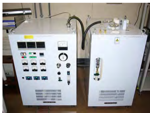
図 2. 金属-炭素共晶点実現装置
