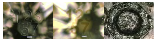
(a)照射前 (b)照射量: 1 \times 10^{14} ions/cm 2 (c)照射量: 5 \times 10^{14} ions/cm 2 レジストを塗布し, 現像した後 レジスト除去後 レジストが炭化
