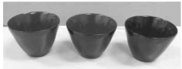
図5. 漆塗装したぐい呑み形状100%バイオマス成形体
