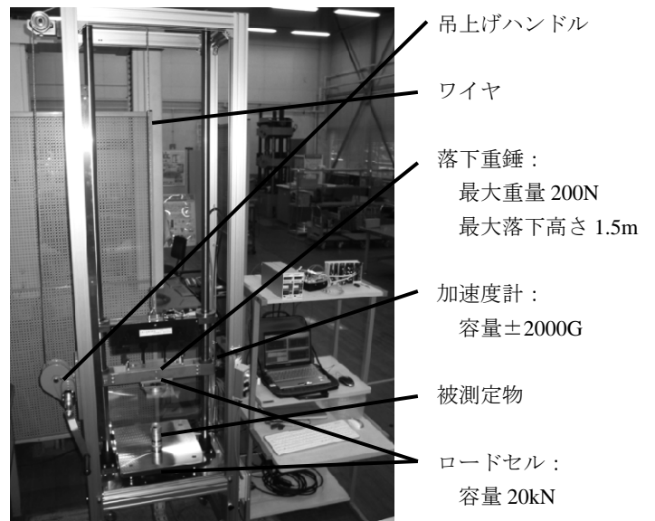
図1. 落錘式衝撃特性評価試験機概要
