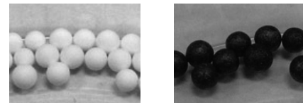
図 1. アルミナ担体 (左) と触媒担持アルミナ (右)
