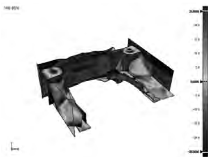
図10. エンジンルームの測定点群と曲面の差分
