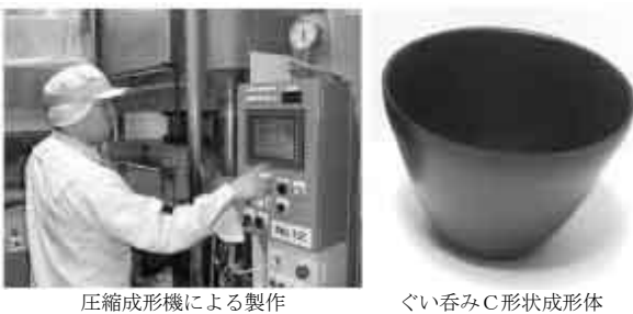
図4. 圧縮成形による100%バイオマス成形体の作成
