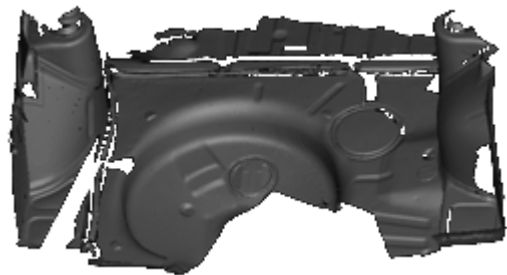
図7. トランクルームの重ね合わせた点群データ
