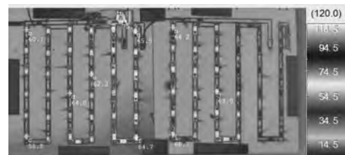
図 4. 倍電圧整流回路を用いたときの表面温度分布写真
