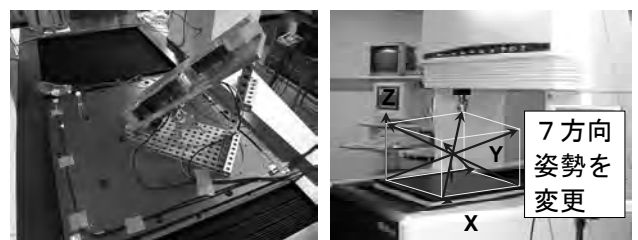
図2. JIS B 7440-2に準拠した定期検査例
