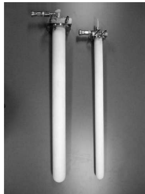
図 2. 左：高精度型共晶点セル，右：実用型共晶点セル
