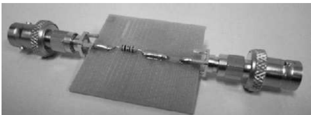
図7. 測定系に挿入した抵抗器
