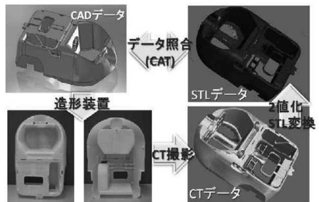
図1.X線CTを利用したデジタルエンジニアリングの例
