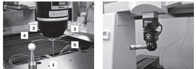
図1. マルチスタイラス 左：固定式マルチスタイラスプロービングシステム 右：回転式プロービングシステム
