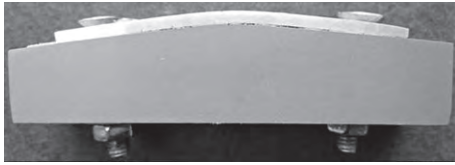
図3. 純水湿気中試験時の応力負荷状況
