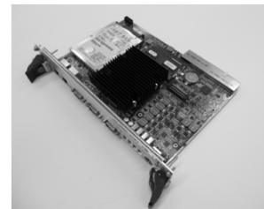
図 1. 開発した産業用コンピュータボード
