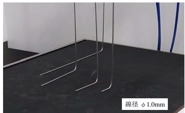
図1. 熱板への熱電対取付け状況
