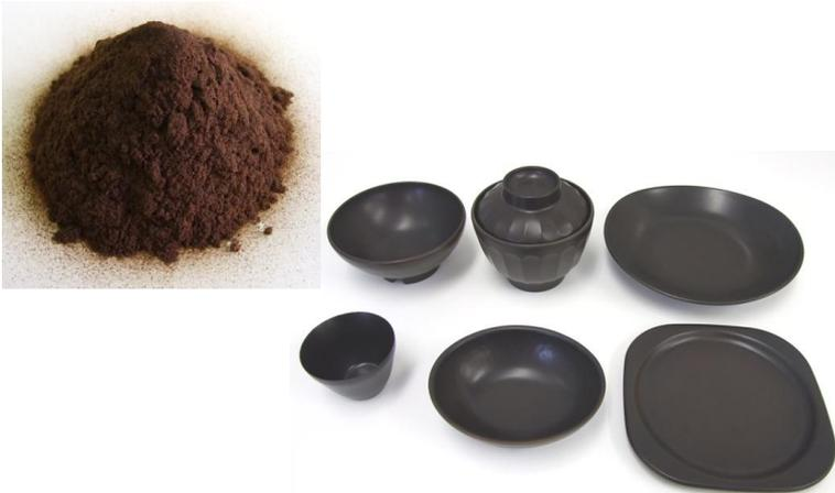
図1 100%バイオマス成形材料・成形体（サスティーム®）
