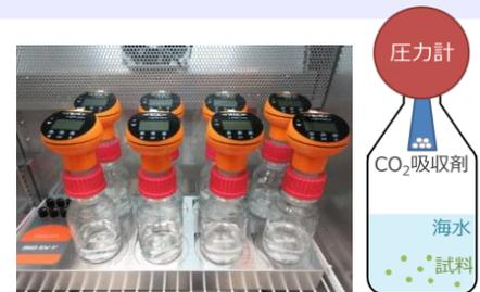
図1 BOD測定の様子(左)と装置模式図(右)
