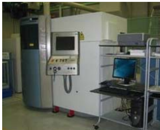
図7 レーザ型彫り装置 6軸の型彫り加工が可能なレーザー型彫り装置です。
