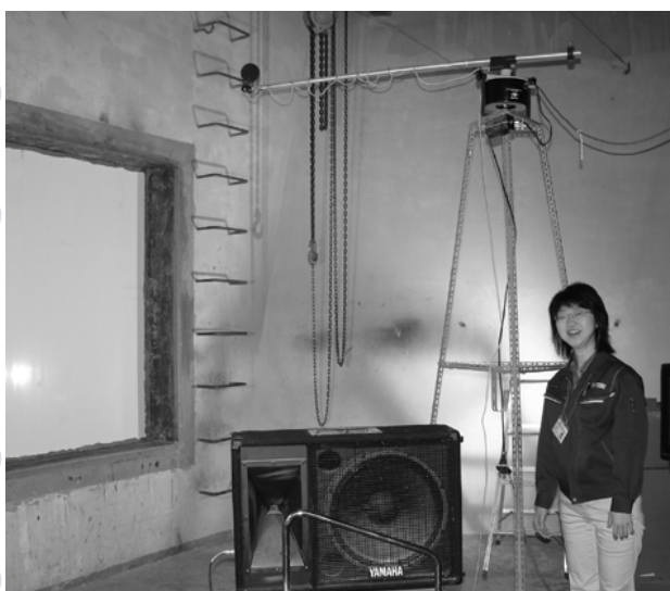
写真6 音響透過損失の測定
