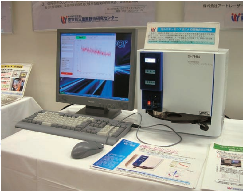
図1 光ルミネッセンス測定装置
