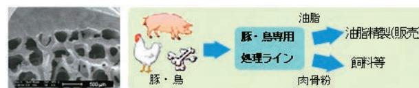
図3 豚骨の断面写真と現在の廃棄物処理 骨には細孔があり、VOC吸着面積を大きくすることが出来ます。
