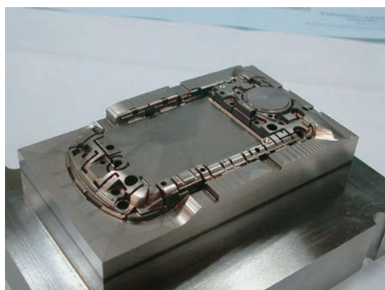
図4 金属光造形複合加工機による加工品 (携帯電話機金型)
