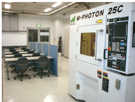
図1 支援センター(発足当時) と金属光造形複合加工機
