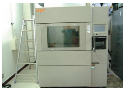
図4 結露サイクル試験装置 テストエリア寸法：W410×H960×D370
