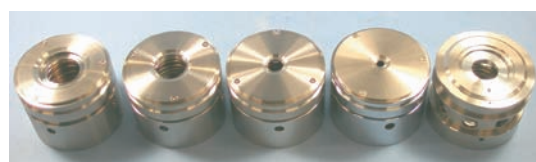
図3 試料ホルダー（内径50×高さ30mm） 左から測定試料径30mm/20mm/10mm/5mm用、マッピング用
