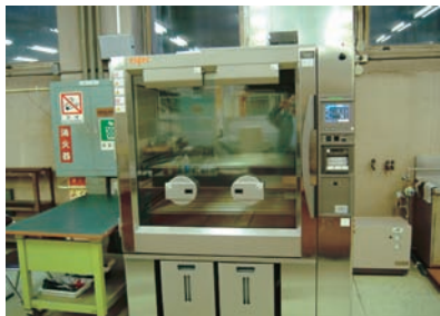
図2 恒温恒湿槽 温度範囲：-40～90℃ 湿度範囲：20～98%rh テストエリア寸法：W960×H960×D800
