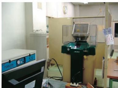
図1 落下衝撃試験装置 試験可能加速度：30G 50G 100G 試料寸法：W230×H230×D230 以下
