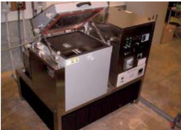
図1 ガス腐食試験機
