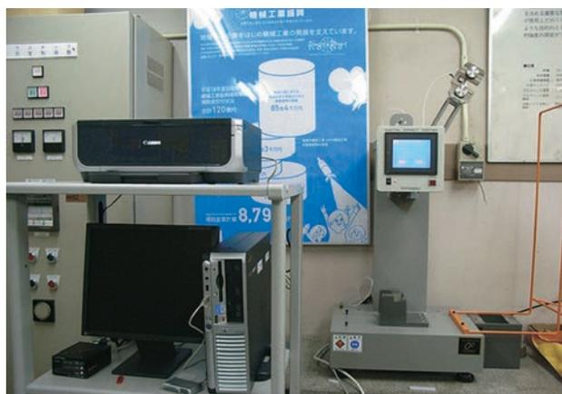
図2 計装化シャルピー衝撃試験機
