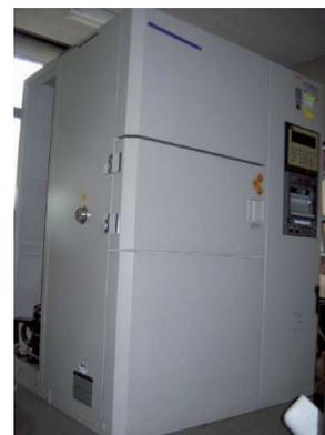
図3 冷熱衝撃試験器
