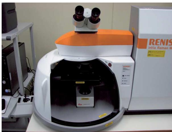
図2 顕微レーザーラマン分光装置の試料室
