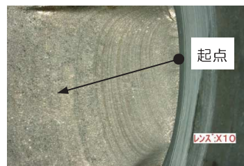
図2. 破断面の縞状模様
