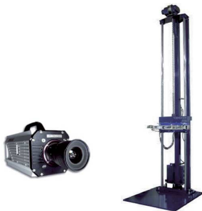
図1 製品落下衝撃試験機と観察に用いる高速度カメラ
