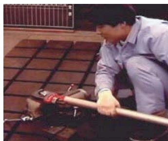
図3 セキュリティボルトの取り外し試験 強力な工具(パイプレンチ)にもしっかりガード
