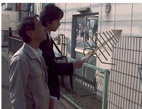
図2 製作アンテナのフィールドテスト
