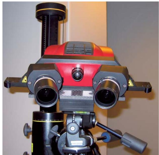
図1 非接触式三次元測定機の概観図
