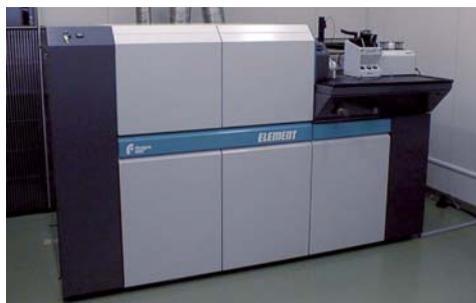
図1 二重収束型高分解能ICP質量分析装置
