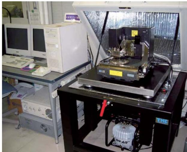
図3 原子間力顕微鏡外観
