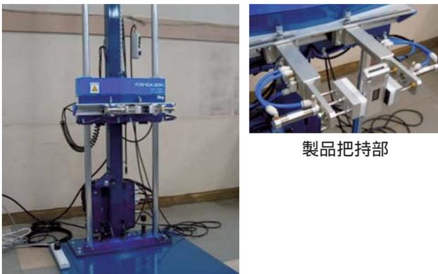
図1 小型製品落下衝撃試験機
