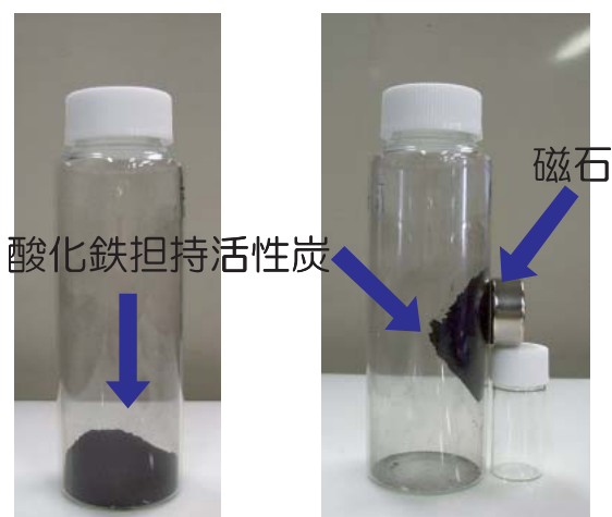
図2 酸化鉄担持活性炭の磁気応答性
