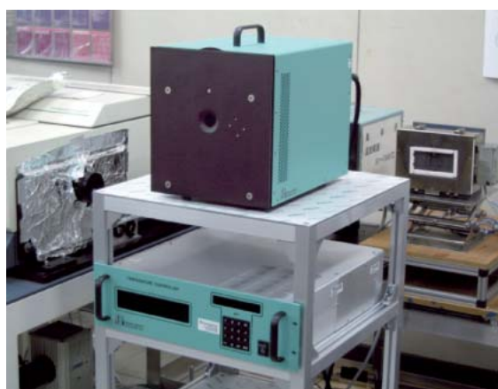
図1 黒体炉とコントローラ 左はFTIR（フーリエ変換赤外分光光度計）
