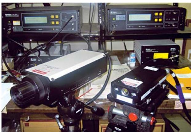
図1 レーザー振動計の光学ヘッド
