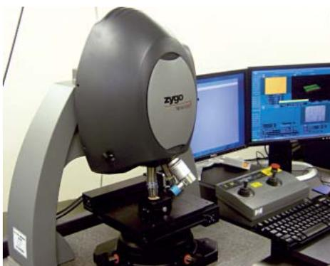
図1 三次元表面形状測定機
