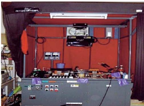
図1 磁粉探傷機
