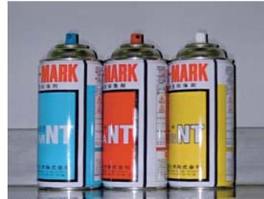
図2 浸透探傷（速乾式スプレー）
