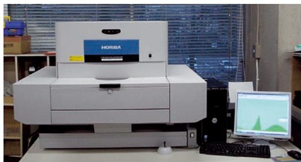
図1 エックス線分析顕微鏡 (大型試料室タイプ)
