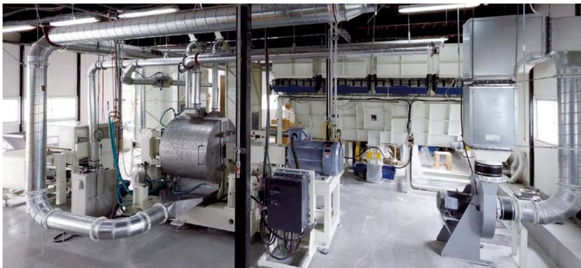
図1 塩ビ系壁紙分離再生装置
