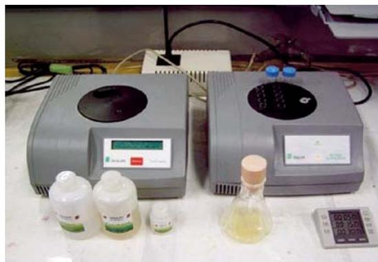
図3 ルミノメーター(左)と冷却ユニット(右)
