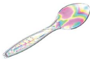
図1 偏光を通して見た透明なスプーン
