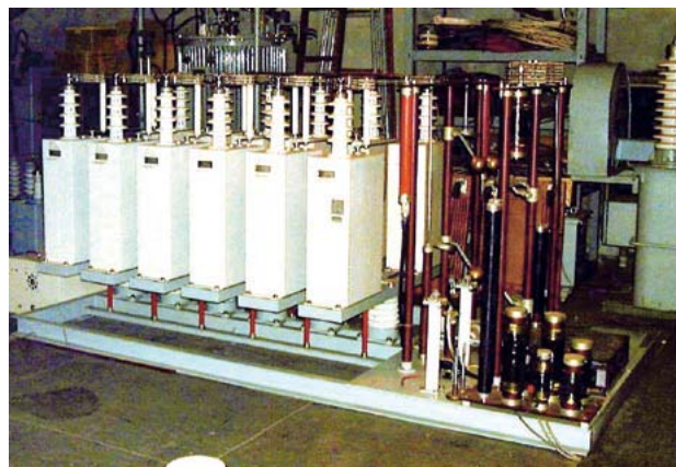
図2 雷サージ電流発生装置 30kAの雷サージ電流を発生します
