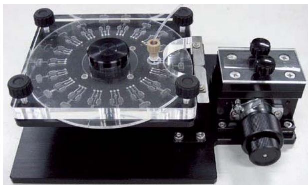
図 極微量分注装置の開発
