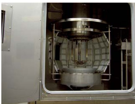
図2 カーボンアーク灯形試験機（上）と試験機内部（下）
