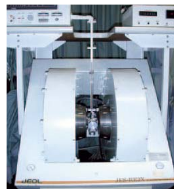
図1 ESR測定装置の本体 中央は、石英試料管を挿入したキャビティ、右上は温度制御装置、左上はマイクロ波発振器と導波管です (写真は現有機 日本電子(株) RE-X)
