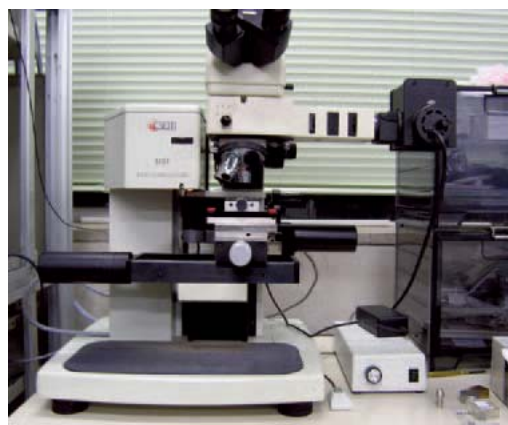
図1 マイクロスクラッチ試験機
