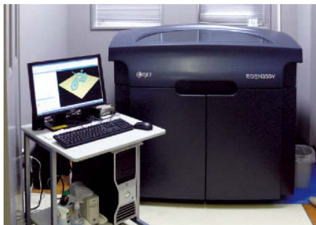
図1 造形装置本体 (Objet社製: EDEN350V)
