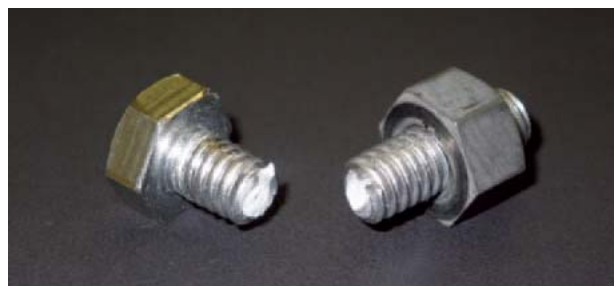
図1 過度の締付けによるボルトの破断
