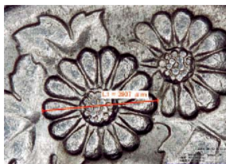
図3 50円硬貨表面 2点間距離の計測例
